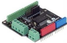
Le pilotage des moteurs sera réalisé avec des cartes de type 'arduino' équipé d'une carte de puissance pour moteur (masse 100g)
